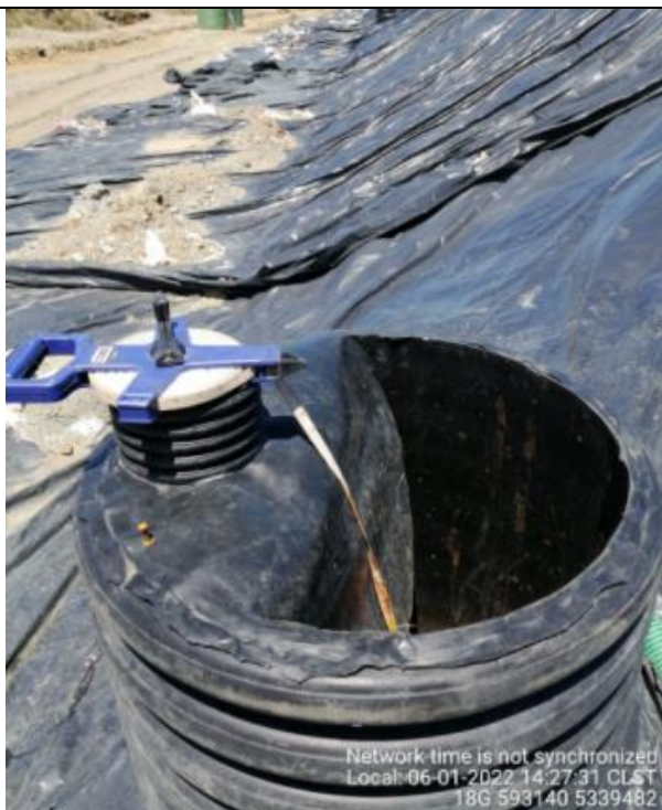
Fotografía N°15: Medición de Niveles de cámaras por Personal Municipal. Tomada: 06 de Enero del 2022.
