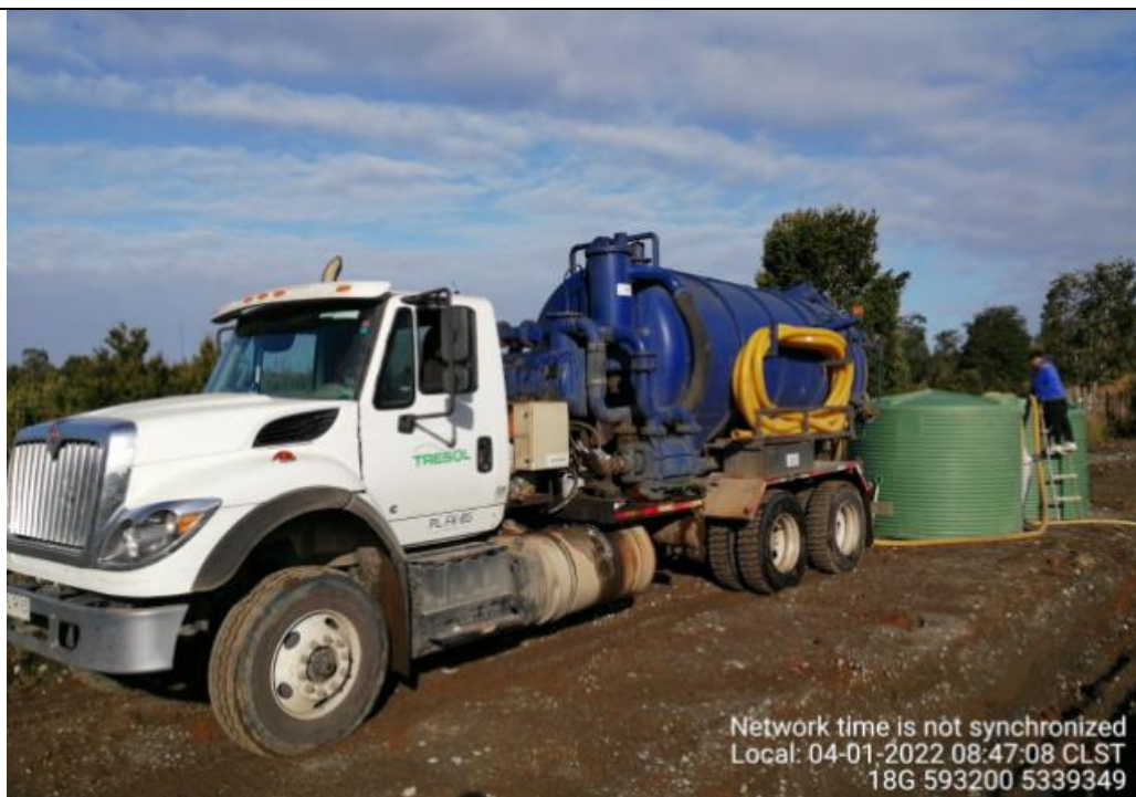
Fotografía N°3: Retiro de Lixiviados por parte de empresa Tresol. Tomada: Martes 04 de Enero del 2022.
